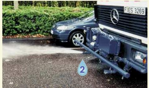
**2** Das Wasser aus dem Tank wird aus den zwei Düsen, die am Schwemmbalken befestigt sind, herausgespritzt. Die Düsen sind verstellbar. Man kann damit gleichzeitig beide Seiten einer Straße bespritzen oder nur nach rechts oder nach links.
