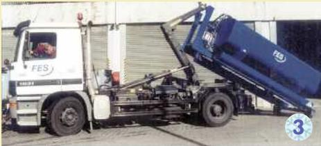
**3** Zunächst wird der Wassertank abgesetzt. Danach der Schwemmbalken abgebaut. Übrig bleibt das reine Fahrgestell.
