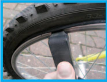
Zuerst stellt ihr das Fahrrad mit den Reifen nach oben **„auf den Kopf“**. Das Rad montiert ihr ab. Dann löst ihr den Reifen an einer Stelle mit dem einen **Reifenheber** von der Felge. Mit dem anderen lässt sich der Mantel dann ringsherum ganz ablösen. Jetzt schraubt alle Teile vom Ventil ab. Danach könnt ihr es durch die Felge nach innen schieben. So lässt sich der Schlauch herausziehen.
