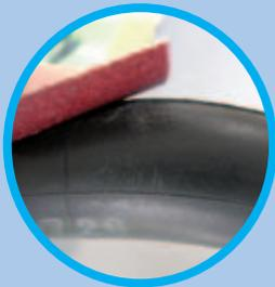
Die Stelle mit dem Loch wird mit dem **Schmirgelpapier** aus dem Flickzeug etwas angeraut. Jetzt kann die **Flüssigkeit aus der Tube** dünn aufgetragen werden. Sie muss etwa 5 Minuten antrocknen.
