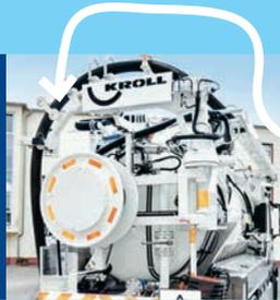
Der Hochdruckspülwagen ist dafür bestens geeignet. Er hat einen langen Saugschlauch und viel Wasser im Tank. Mit dem Schlauch wird zunächst aller Unrat aus dem Kanal herausgesaugt. Danach wird das Kanalrohr mit viel Wasser und Druck kräftig durchgespült. So wird es sauber und frei.
